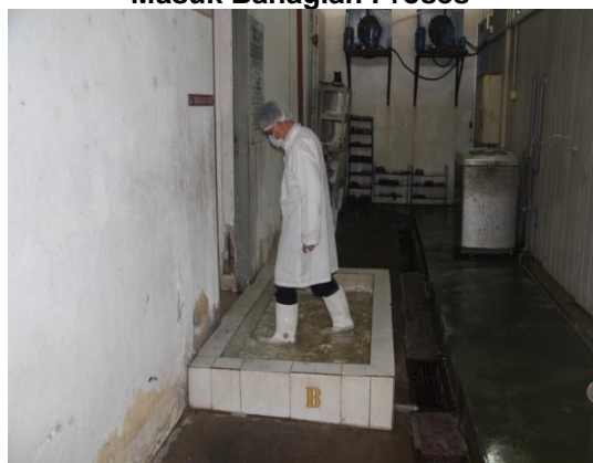
Gambar 3.9 Takungan Air Bersih Disediakan Di Pintu Masuk Bahagian Proses
